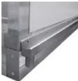
Отводные желобы, предназначенные для отвода моющих средств, выполнены из кислотостойкой стали и устанавливаются снаружи установки.
