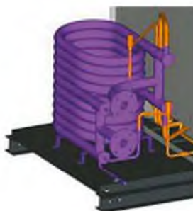
Испаритель типа «труба в трубе»
