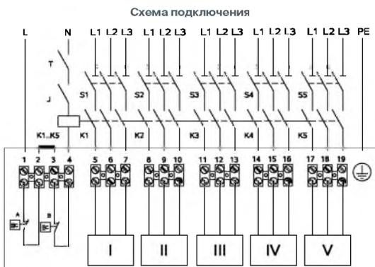
**Маркировка электрического подключения**
