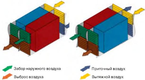
Таким образом, когда один теплообменник быстро нагревается потоком вытяжного воздуха, другой теплообменник быстро охлаждается потоком приточного воздуха, после чего происходит смена потоков воздуха и цикл повторяется.
