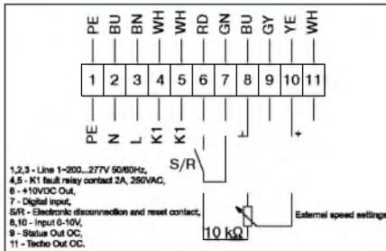
Схема подключения № 2
