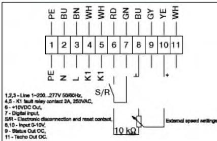
Схема подключения № 2
