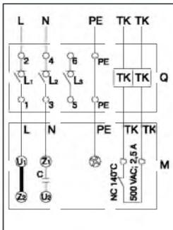
Схема подключения № 2
