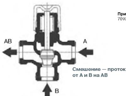
Порт АВ — постоянный расход (на выходе клапана).
